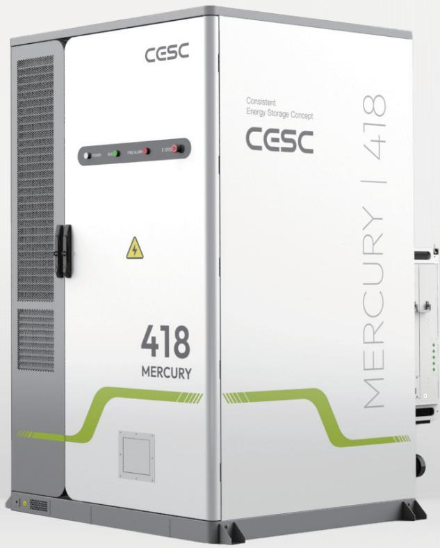
Der **Mercury 418** ist ein flüssiggekühltes, integriertes Energiespeichersystem für kleine bis mittlere gewerbliche und industrielle (C&I) Anwendungen. Durch mehrschichtige Sicherheitskonzepte und intelligente BMS/EMS-Integration verwaltet er Energie hocheffizient – unterstützt durch VPP-Anbindung, Lastmanagement (Demand-Side Management) und Echtzeit-Netzführung. Dies optimiert den Einsatz für Lastspitzenglättung (Peak Shaving), Notstromversorgung und die Integration erneuerbarer Energien.
